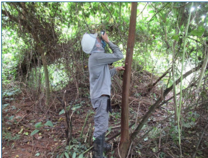
Foto 5.2 – Medição de altura com auxílio de trena a laser durante o inventário florestal.
