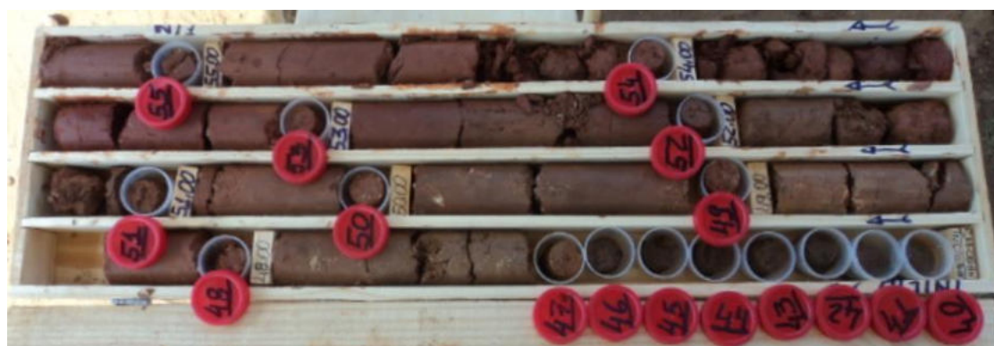
Figura 7-18 – Dique de partida identificado na sondagem SM-08, a partir dos 47 metros.
