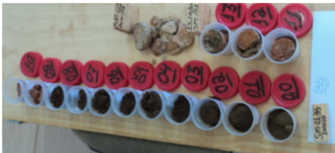
Figura 7-17 – Rejeito underflow, encontrado no SM-01 até 9 metros.
