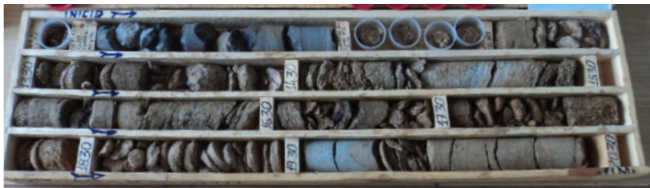
Figura 7-12 – Xisto alterado e fraturado, presente na sondagem SM-10.
