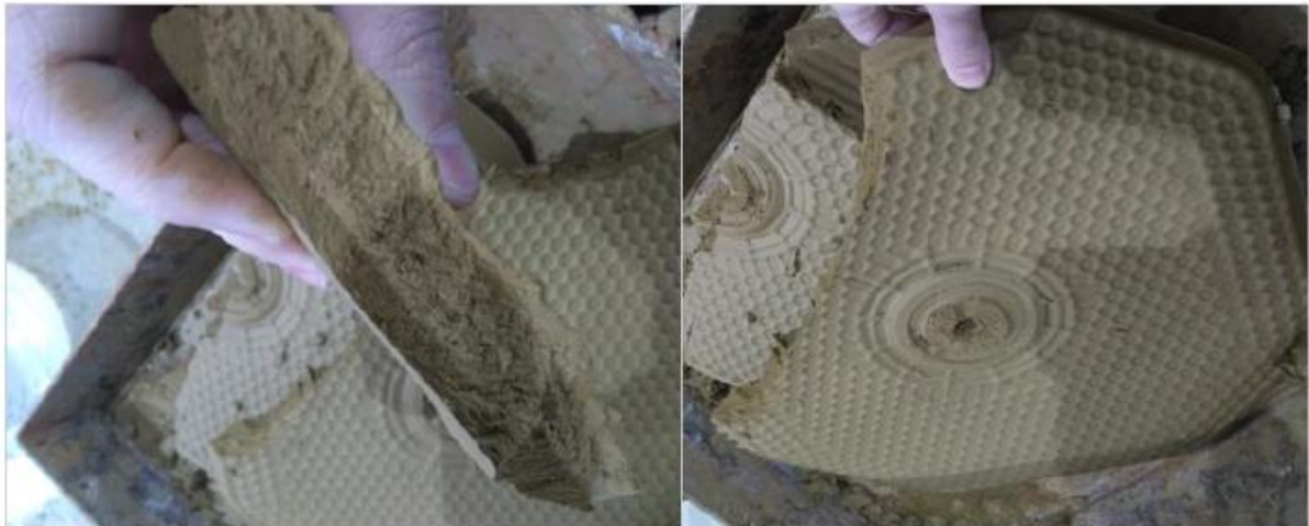
Foto 4.1 – Produto final das lamas de CMT, após utilização do filtro-prensa piloto da empresa Andritz.
