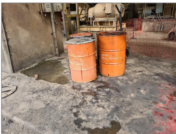
Foto 6.27 – Bombonas contendo óleo armazenadas sem caixa de contenção.
