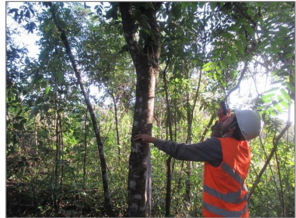
Foto 6.47 – Medição de altura em unidade amostral do inventário florestal, com auxílio de trena a laser .
