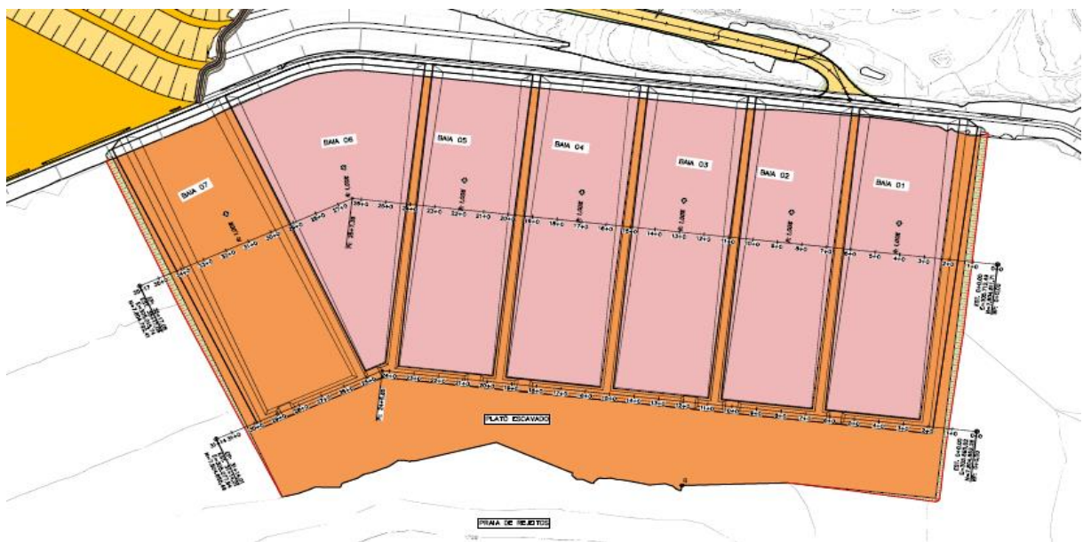
Figura 5.25 – Planta das baias de desaguamento de rejeitos.
