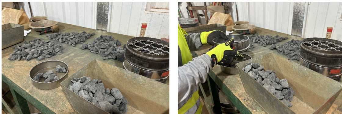
Figura 63 – Controle de qualidade e especificações realizado pela fiscalização – Ensaio de granulometria no material do enrocamento recebido.
