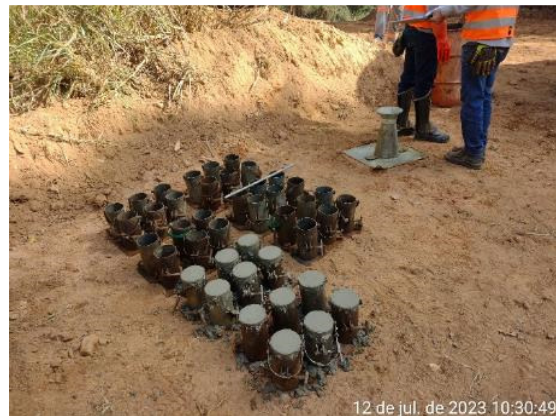
Figura 6.53 – coleta de amostras para ensaios de trabalhabilidade e resistência a compressão.
