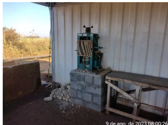
Figura 6.54 – tanque para conservação dos corpos de prova e prensa utilizada nos ensaios de resistência a compressão.
