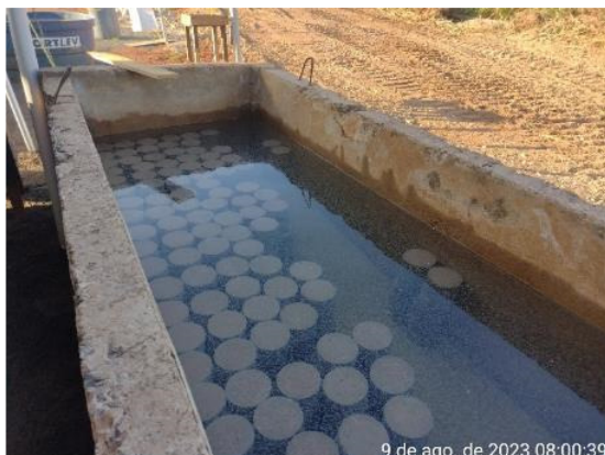
Figura 6.54 – tanque para conservação dos corpos de prova e prensa utilizada nos ensaios de resistência a compressão.
