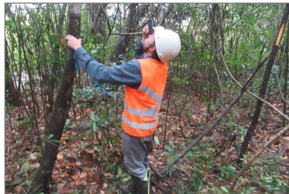
Foto 6.45 – Medição de altura em unidade amostral do inventário florestal, com auxílio de trena a laser.
