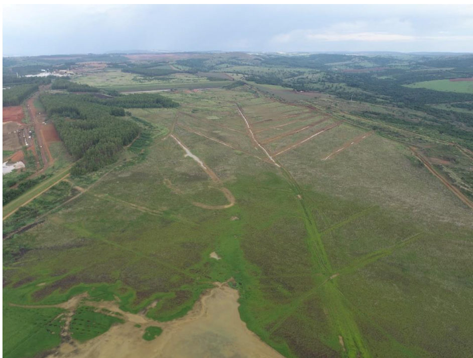
Figura 7.12 - Vista área dos canais em espinhas de peixe para drenagem do reservatório (03/11/2022).
