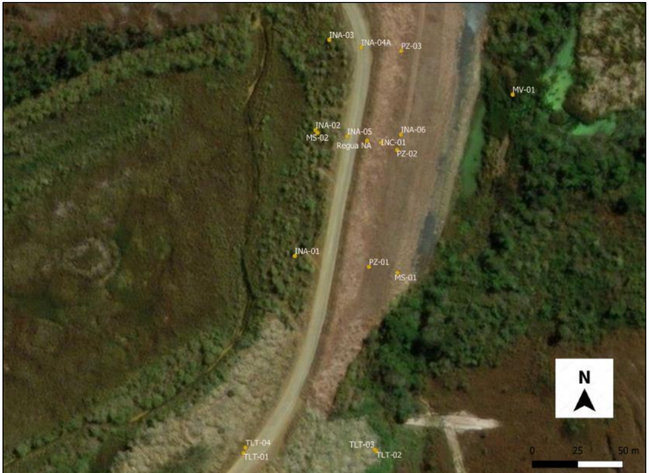
Figura 11.1 - Planta de locação da Instrumentação existente na Barragem BD2.
