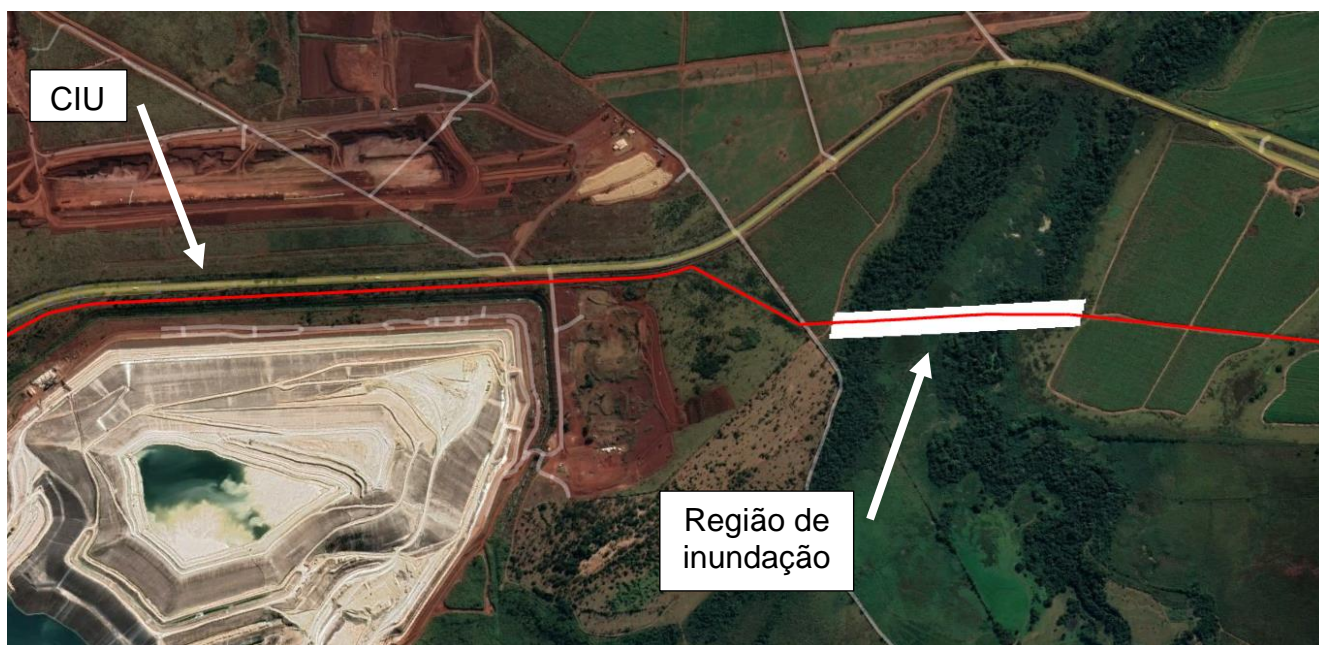
Figura 2 - Região de inundação onde será implantado o acesso para manutenção do mineroduto
