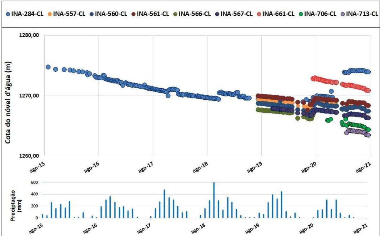
Figura 4.18: Evolução da cota do nível d'água dos instrumentos localizados na região da cava Leste. Intervalo B.
