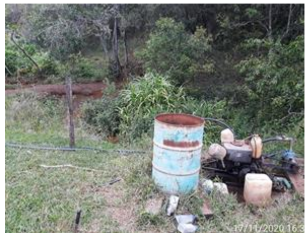
Foto 7.2: Bomba a diesel a jusante do poço escavado (CMT-US-01).
