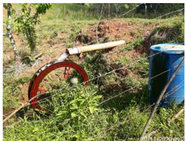
Foto 7.12: Roda d'água utilizada para bombeamento (CMT-US-29A).
