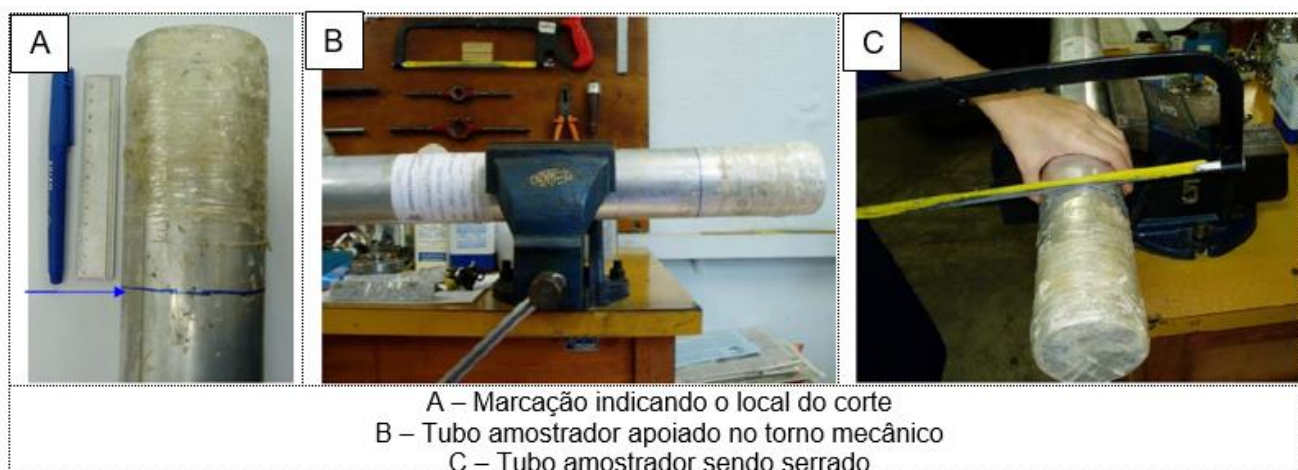
Figura 6.4 - Extração de amostras indeformadas.
