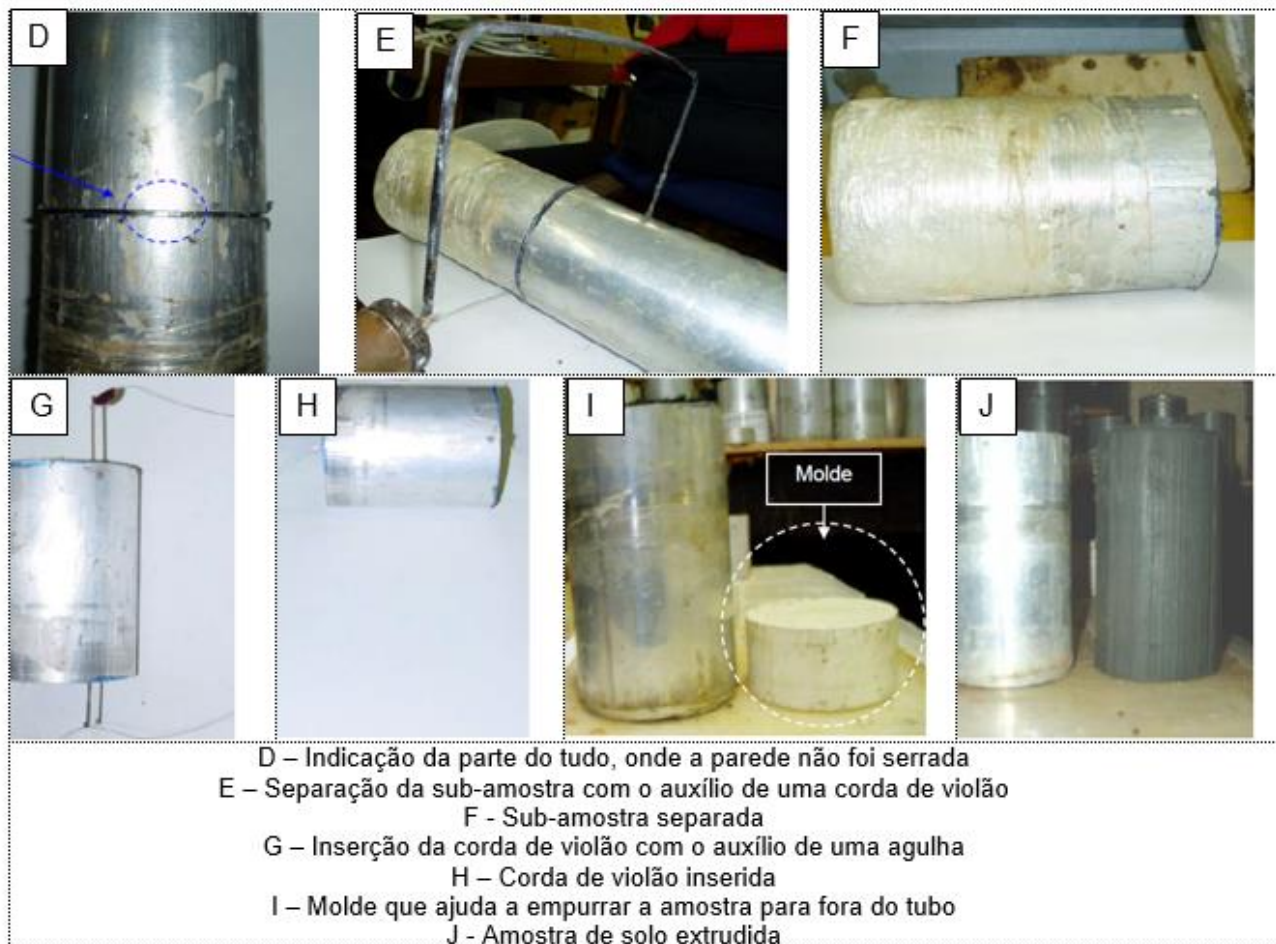
Figura 6.5 - Extração de amostras indeformadas (continuação).
