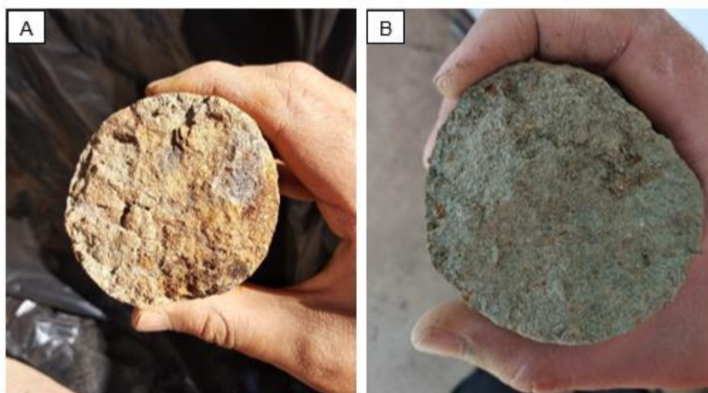
Figura 8.16 - A) Saprólito de rocha intrusiva alcalina da SM-04. B) Saprólito de rocha intrusiva alcalina da SM-06.
