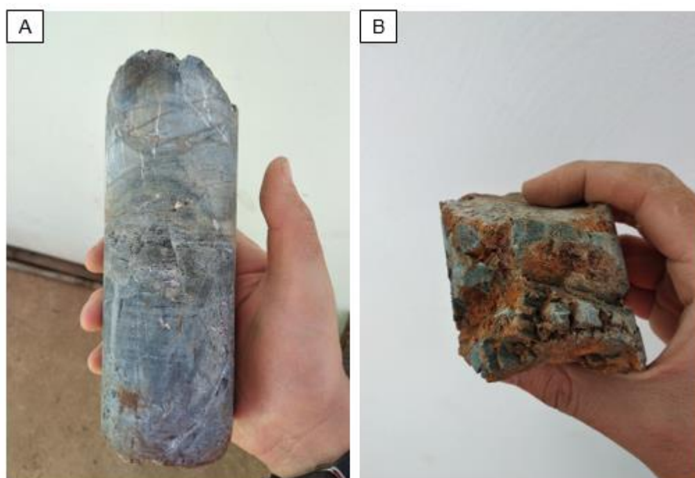
Figura 8.17 - A) Rocha intrusiva alcalina levemente alterada e com vênulas de carbonato de cálcio da sondagem SM-06. B) Rocha intrusiva alcalina moderadamente alterada e com descontinuidades apresentando alteração mineral, conferindo coloração ocre da sondagem SM-06.
