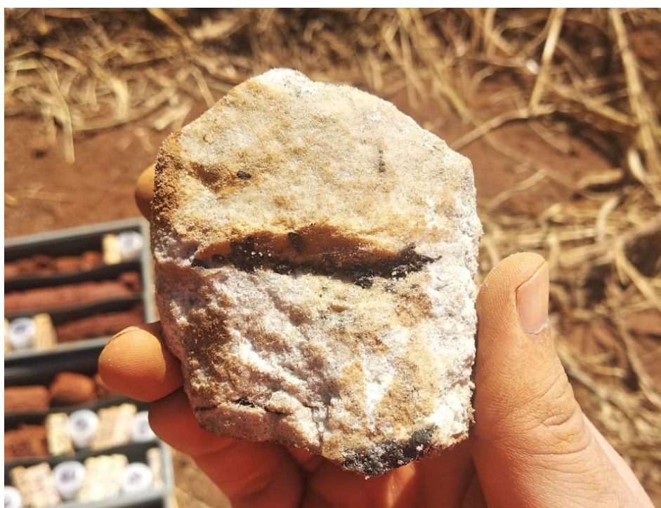
Figura 8.14 - Saprólito de quartzito do Grupo Canastra da caixa de testemunhos da SM-05.
