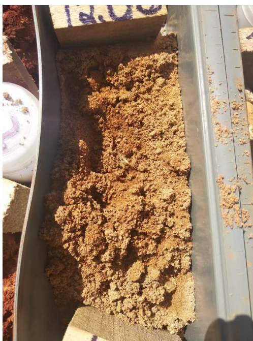
Figura 8.13 - Aspecto do solo residual de quartzito do Grupo Canastra na caixa de testemunhos da SM-05.
